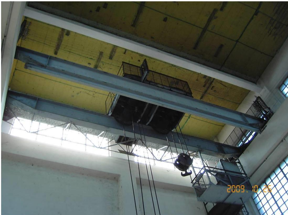
Figura 4-18: carroponne bitrave da 50 tonnellate
