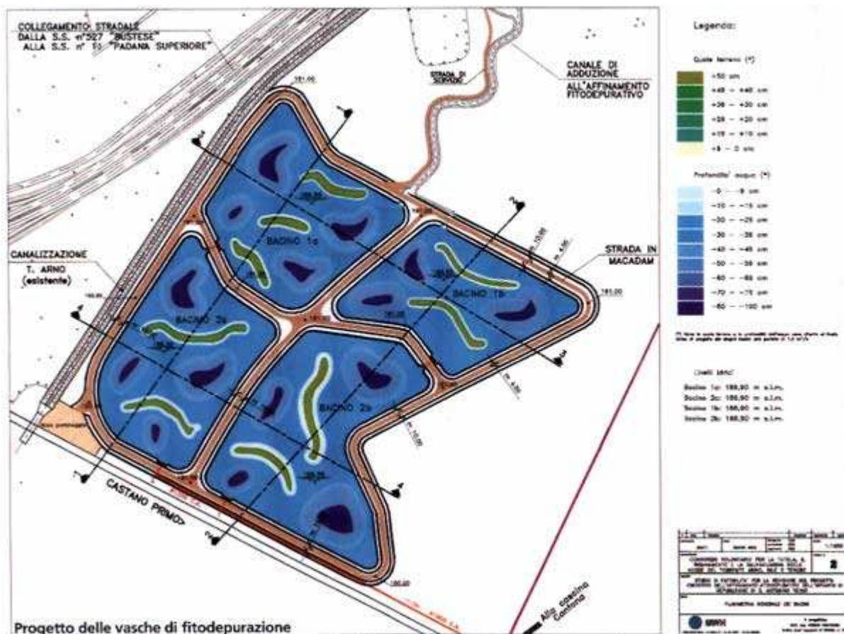
Il Progetto delle vasche di Fitodepurazione. Il Parc o del Ticino si occuperà della loro naturalizzazione.
